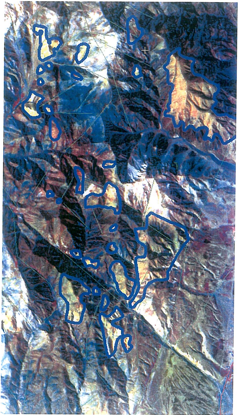
تصویر شماره ۱۷: در تصویر بالا توده های نفوذی (آلکالی گرانیت) با لایه گرافیکی آبی تشکیل شده و همچنین گسل های این محدوده نگاشت شده است.
