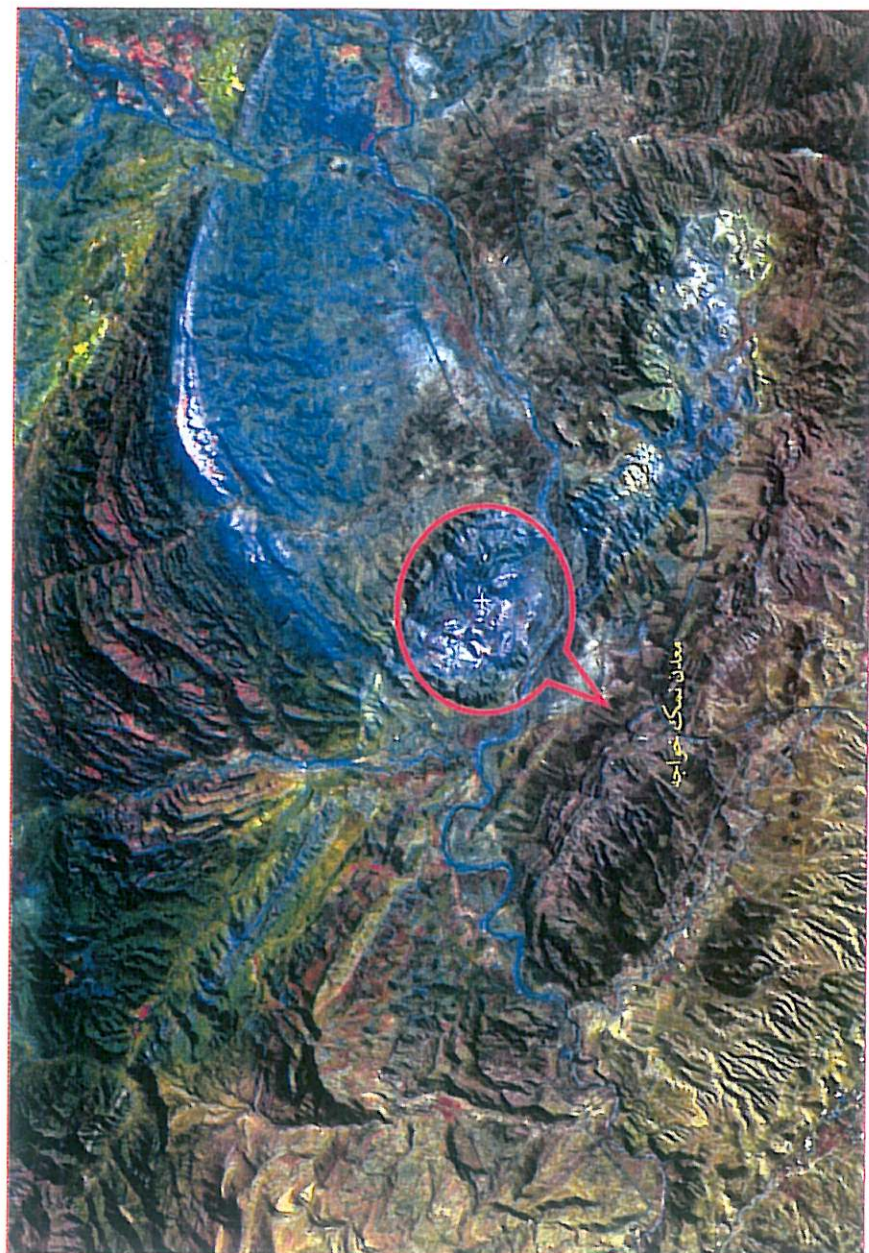
تصویر شماره ۱۰: در تصویر مجازی حاصل از باندهای ۵۳، ۱ که در آن گنبد نمکی، ناشی از عملکرد گسلهای منطقه نشان داده شده است
