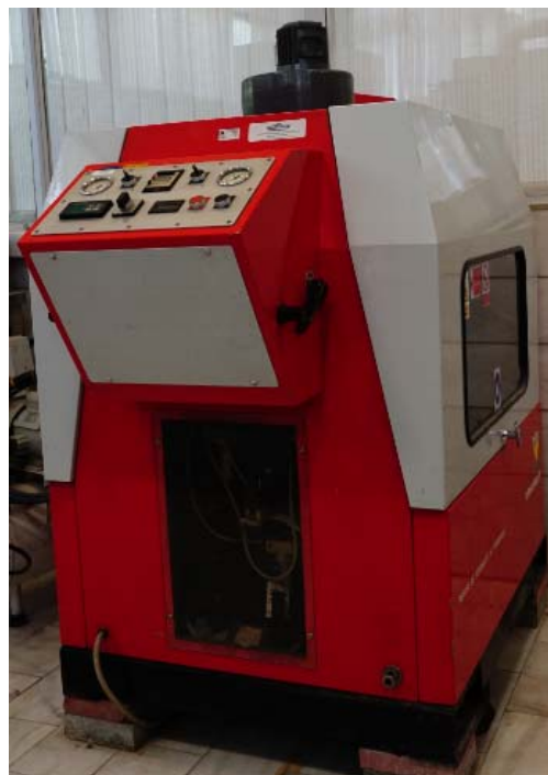
شکل ۳- دستگاه شیارافتادگی چرخ بزرگ فرانسوی آزمایشگاه فنی و مکانیک خاک
