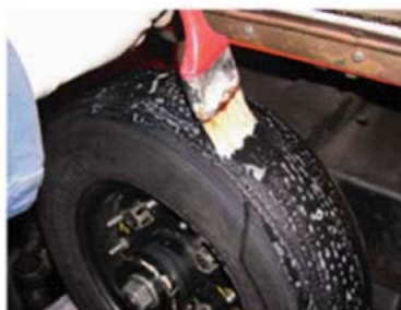
شکل ۲- استفاده از کاغذ آشپزی و صابون گریسی به منظور جلوگیری از چسبیدن مخلوط آسفالتی به چرخ
