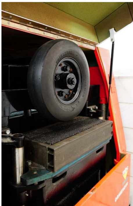
شکل ۳- دستگاه شیارافتادگی چرخ بزرگ فرانسوی آزمایشگاه فنی و مکانیک خاک
