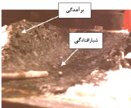
تصویر سطح نمونه با عمق شیار بیش از ۱۸ میلیمتر
