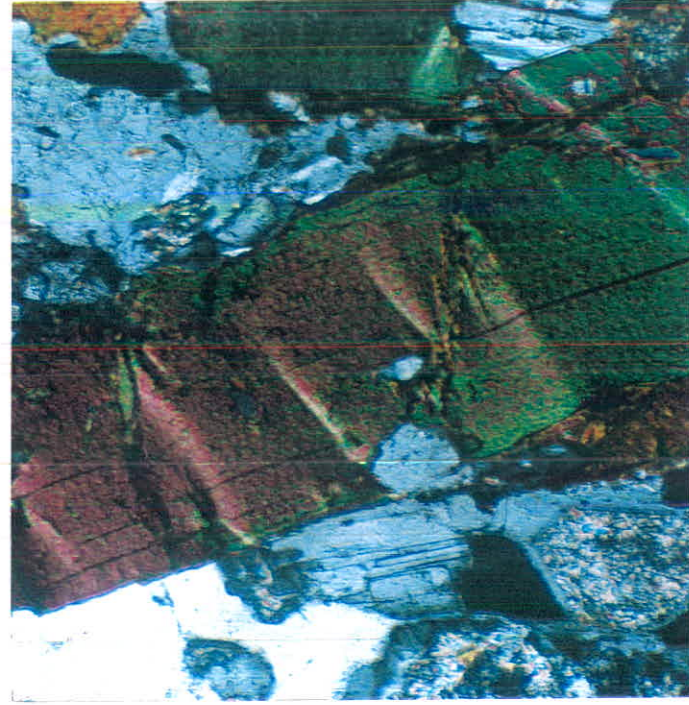
عکس شماره ۲۳۲ - نشان دهنده نور شکج نامتقارن در یکی از بلورهای بیوتیت است ( \perp 6.3 \times 10 \times )
