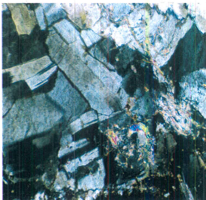
عکس شماره ۳۰P - نمایی از بافت دانه ای هیپی دیومورفیک در مونزودیوریت پگماتیته را نشان می‌دهد (X 6.3×10)
