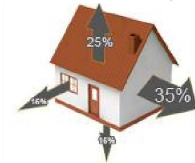
شکل ۱-۸- شمای افت حرارت برای یک ساختمان متداول
