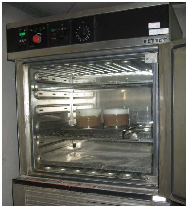
شکل ۲-۱۴ گرمخانه برای نگهداری دمای محیط آزمون در ۲۳ درجه سلسیوس
