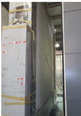
شکل ۳-۳ نصب ترموکوپل‌ها در مرکز قاب
