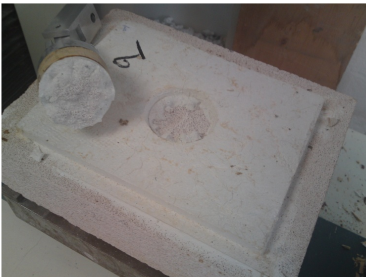
شکل ۲-۱۲- گسیختگی ایجادشده در آزمون ملات اندودکاری با مشخصه ۹ (مطابق با الگوی گسیختگی پ)
