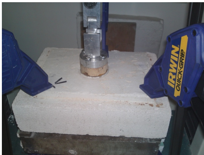
شکل ۲-۹ آماده‌سازی آزمونه ملات اندودکاری با مشخصه ۷ برای انجام آزمون چسبندگی
