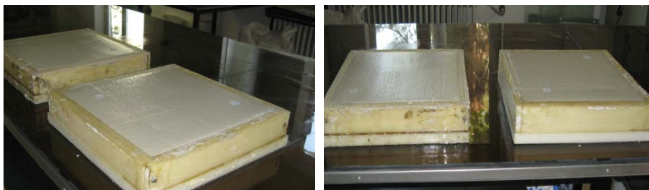
شکل ۲-۱۵ نمونه‌های ساخته شده برای اندازه‌گیری ضریب هدایت حرارتی
