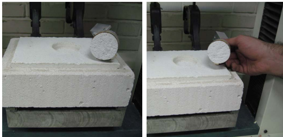
شکل ۲-۱۷ گسیختگی ایجاد شده در آزمون ملات اندودکاری سبک و عایق حرارتی وارداتی پس از آزمون چسبندگی
