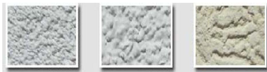
شکل ۱-۱۰ نمونه‌هایی از اندودهای آکرلیکی اجرا شده دارای سنگدانه
