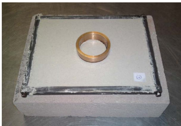
شکل ۲-۵- آزمونه ساخته شده برای آزمون اندازه‌گیری مقاومت چسبندگی
