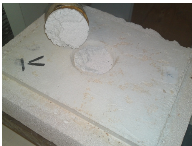
شکل ۲-۱۰ گسیختگی ایجادشده در آزمونه ملات اندودکاری با مشخصه ۷ (مطابق با الگوی گسیختگی ب)
