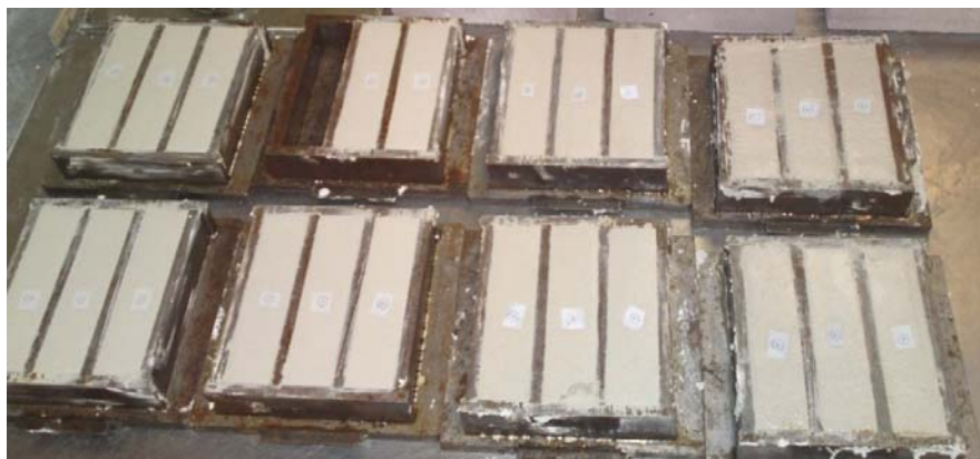
شکل ۲-۳ آزمون‌های ساخته شده برای آزمون‌های اندازه‌گیری مقاومت فشاری، چگالی و ضریب جذب آب موئینه
