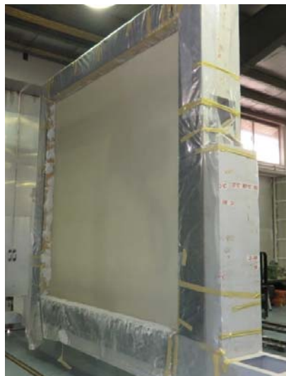
۲-۳ دیوار در حین و بعد از اجرای ملات اندودکاری سبک و عایق حرارتی
