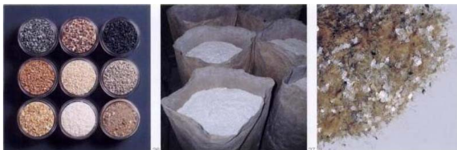
شکل ۱-۶ انواع سنگدانه، افزودنی و افزونه مورد استفاده در اندودکاری (به ترتیب از چپ به راست)
