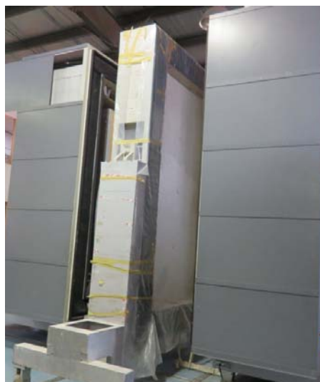
شکل ۳-۴ قرارگرفتن دیوار با ترموکوپل‌ها درون دستگاه اندازه‌گیری ضریب انتقال حرارت
