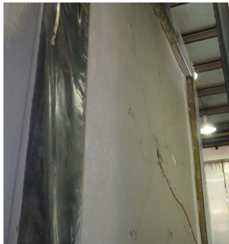
شکل ۳-۳ نصب ترموکوپل‌ها در مرکز قاب
