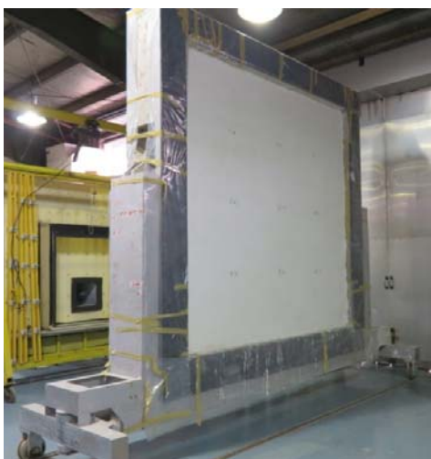
شکل ۱-۳ سامانه دیوار ساخته شده با بلوک‌های سفالی بدون اجرای ملات اندودکاری منتخب در پروژه
