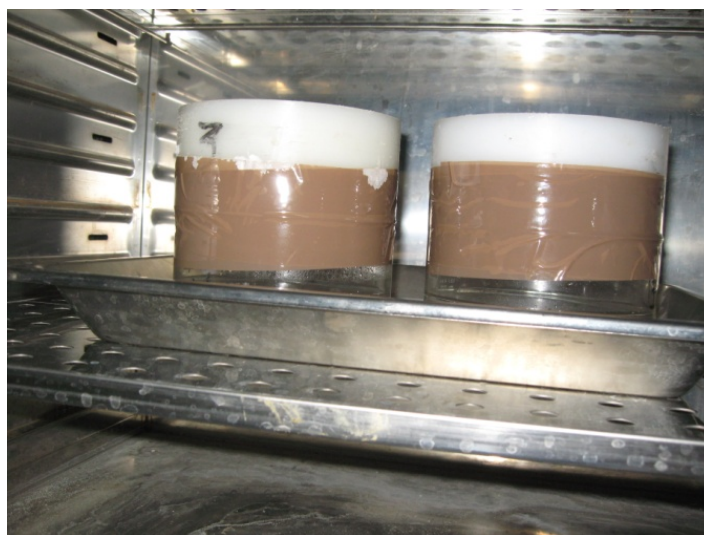
شکل ۲-۱۳ ظرف‌های آزمون نفوذپذیری بخار آب به همراه آزمون‌ها
