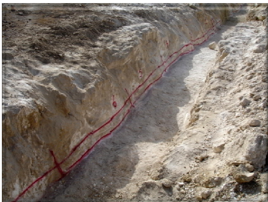
تصویر 3-9: تفکیک لایه‌های سنگ گچ بر اساس تغییرات رخساره‌ای، رنگ و ... با استفاده از اسپری رنگ ضد آب.
