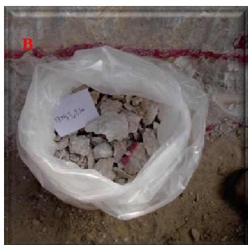
تصویر 3-10: A) نمونه برداری در امتداد کانالی به ضخامت 15 تا 20 سانتیمتر از لایه ی سنگ گچ در دیواره ی ترانشه شماره 1. B) ریختن تکه های نمونه در کیسه ی نمونه و جمع آوری کیسه های نمونه جهت انتقال و بارگیری
