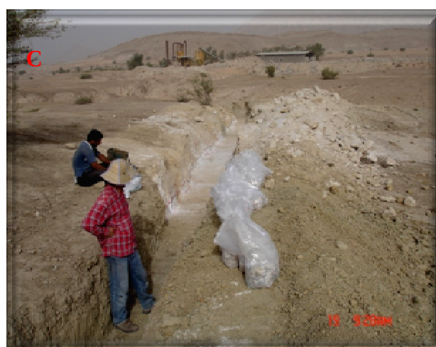
تصویر 3-10: A) نمونه برداری در امتداد کانالی به ضخامت 15 تا 20 سانتیمتر از لایه ی سنگ گچ در دیواره ی ترانشه شماره 1. B) ریختن تکه های نمونه در کیسه ی نمونه و جمع آوری کیسه های نمونه جهت انتقال و بارگیری
