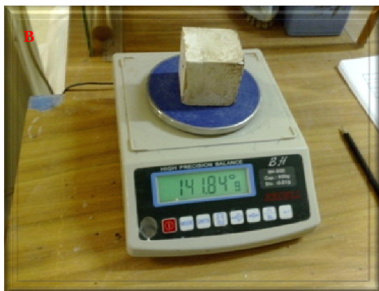
تصویر 10-1 (A & B): وزن کردن نمونه‌های خشک‌شده‌ی مکعبی شکل برای تعیین دانسیته.
