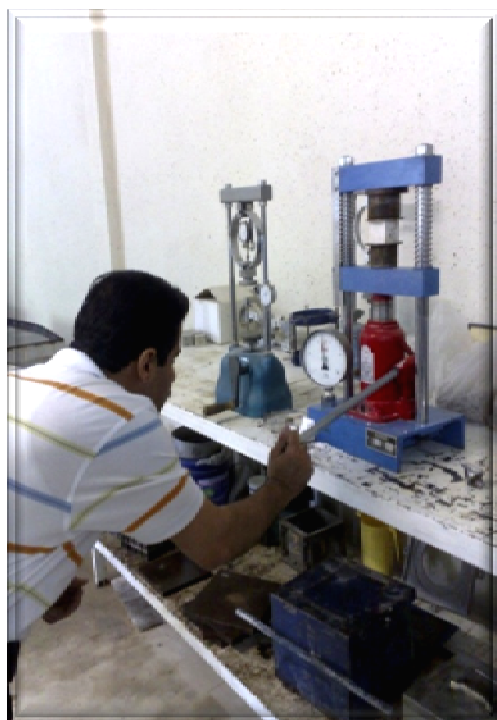
تصویر 1-7: قرار دادن نمونه‌های مکعبی تهیه شده زیر دستگاه پرس (point load) جهت تعیین مقاومت فشاری.
