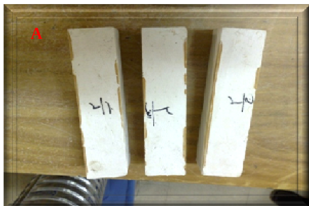
تصویر 1-9: A) نمونه‌ها پس از خارج کردن از قالب و خشک کردن. B) دستگاه مقاومت تک‌محوری (ویکات اصلاح‌شده گچ) جهت تعیین مقاومت خمشی.
