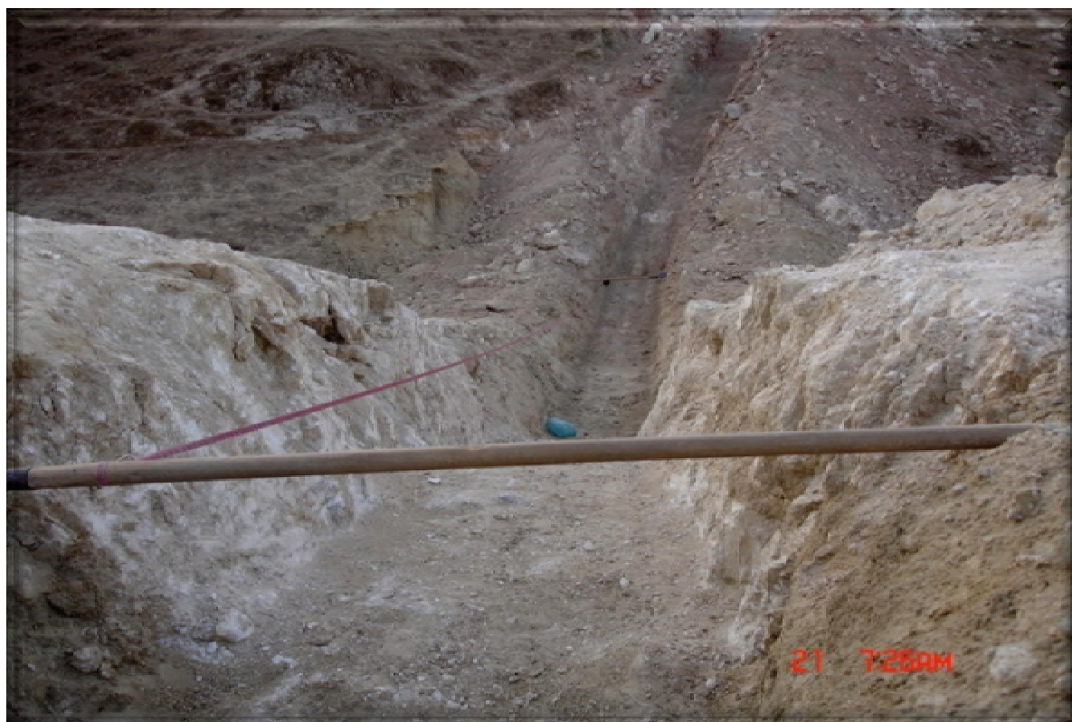
تصویر 3-5: استقرار متر جهت اندازه‌گیری مورفولوژی و همبری رخساره‌های سنگی در ترائشی اکتشافی شماره 2 (دید به سوی باختر).
