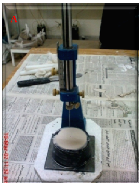
تصویر 1-5: (A) دستگاه ویکات و بُر کردن حلقه‌ی مخروطی آن از خمیر گچ. (B) نفوذ سوزن به درون خمیر جهت تعیین زمان گیرش.
