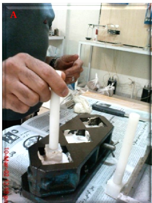
تصویر 1-6: (A) پر کردن قالب‌ها جهت تهیه نمونه‌های مکعبی. (B) صاف نمودن سطح روی نمونه‌ی درون قالب پس از سفت شدن ملات.
