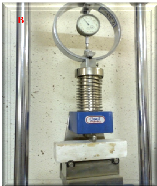
تصویر 1-9: A) نمونه‌ها پس از خارج کردن از قالب و خشک کردن. B) دستگاه مقاومت تک‌محوری (ویکات اصلاح‌شده گچ) جهت تعیین مقاومت خمشی.
