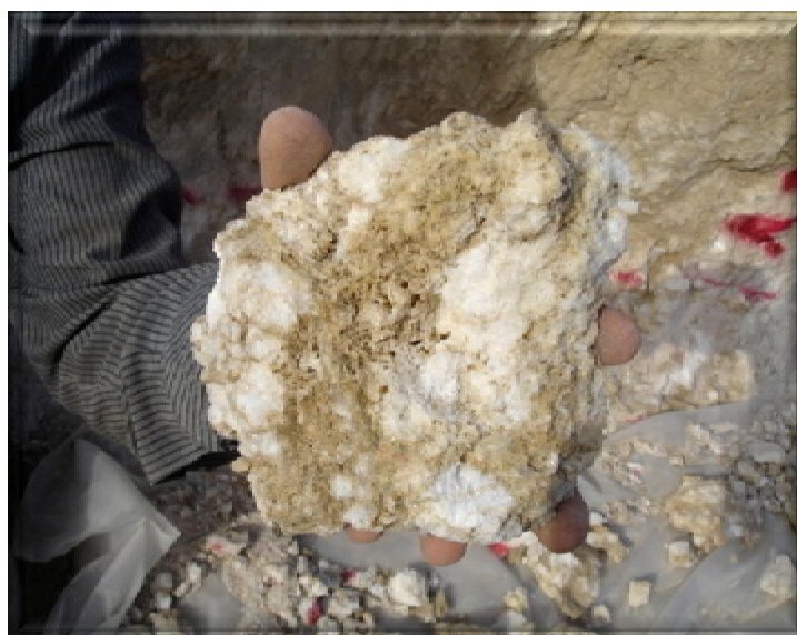
تصویر 2-5: نمایی از بافت دانه شکری در واحد سنگ گچ مربوط به محدوده‌ی اکتشافی.
