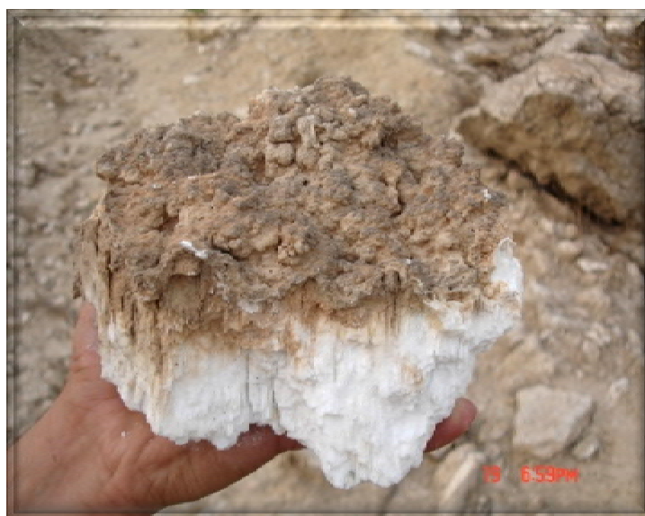
تصویر 2-3: نمایی از بافت رشته‌ای سنگ گچ در محدوده‌ی اکتشافی.
