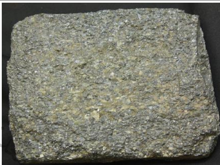
شکل ۱-۴- کانسنگ آر معدن کایرونا شامل کانیهای مگنتیت و آپاتیت از مالمبرگ سوئد (Neukirchen and Ries, 2019).
