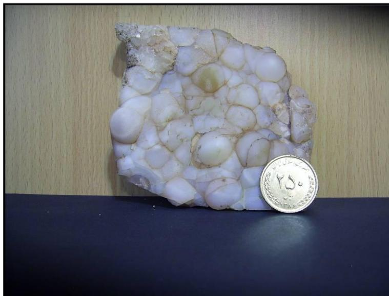
تصویر ۷: نمونه‌ای از سیلیس موجود در محدوده جنوب ترود با بافت قلوه‌ای (تشکیل شده در شرایط هیدروترمال)
