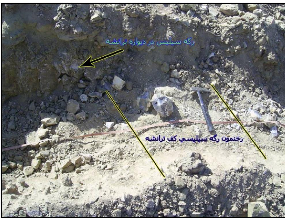
تصویر ۲۷: نمایی از رگه سیلیسی موجود در دیواره و کف ترانشه T-J-1
