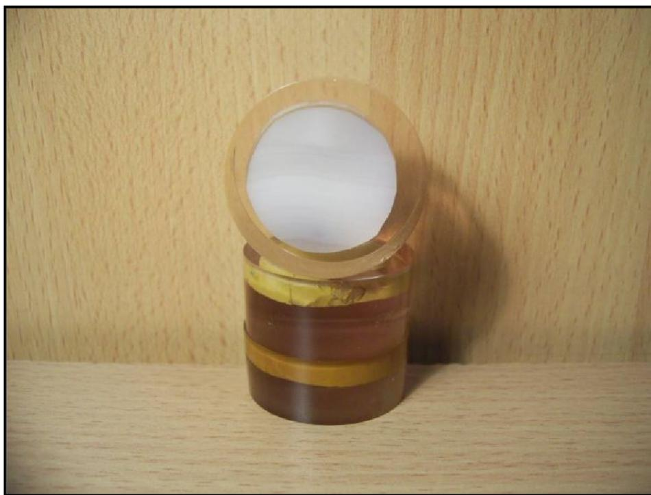
تصویر ۹۶: مقطع تهیه شده از سیلیس خاکستری رنگ نقش دار محدوده کاهوان جهت تعیین سختی
