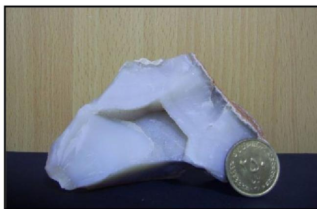
تصویر ۱۵ : نمایی از ژئود کلسدوئن موجود در محدوده جنوب ترود
