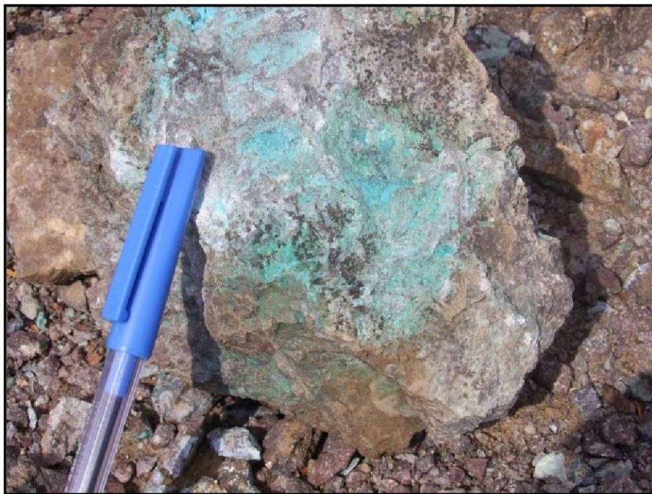
تصویر ۸۴: نمایی از یک نمونه دستی حاوی رگه و لکه‌هایی از فیروزه
