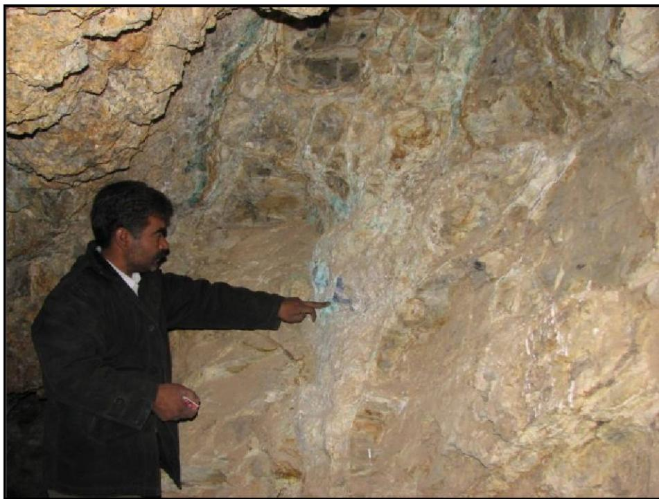
تصویر ۷۴: نمایی از رگه-رگچه‌های نازکی از فیروزه در داخل تونل معدنکاری شده
