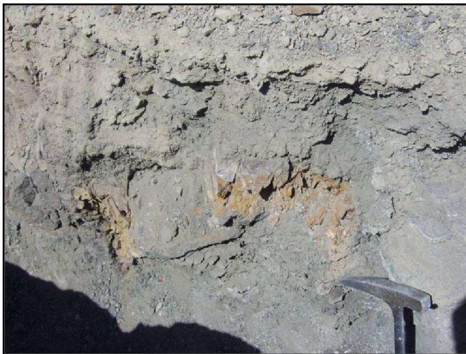
تصویر ۶۳: نمایی از رگه ژاسپ موجود در دیواره ترانشه T-KJ-1
