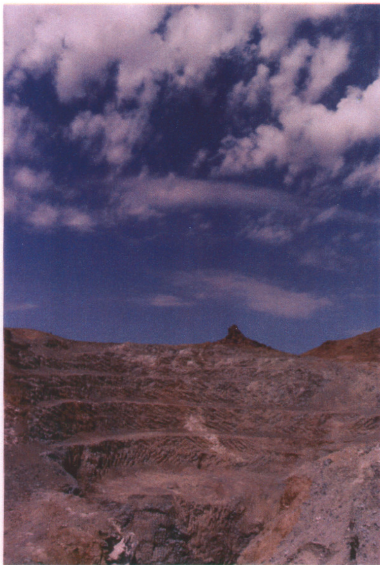
نمای کلی یکی از سینه کارهای معدن کرومیت فرومد عملیات استخراج پلکانی در عکس مقابل مشاهده می شود (کارگاد کاریز شهر)
