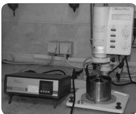
لوله مؤینه، ویسکومترهای چرخشی دارای قابلیت بالایی هستند و می‌توان از آنها برای قیرهای اصلاح شده و نشده استفاده نمود. در این روش آزمایش، میزان نرخ برشی واردہ به ماده قیری قابل کنترل است و می‌توان اثر آنرا بر ویسکوزیته قیر ارزیابی نمود.
