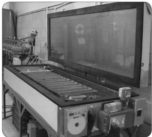
کاهش در مدول پس از اعمال تعدادی از چرخه های بخ زدن و آب شدن، معرف کاهش دوام بتن است. در روش ASTM C666، معمولاً بخ زدن و آب شدن تا ۳۰۰ چرخه و یا تا زمانی که مدول الاستیسیته نمونه بتنی به ۶۰ درصد مقدار اولیه خود کاهش یابد (هر کدام زودتر اتفاق افتاد) ادامه داده می شود.
