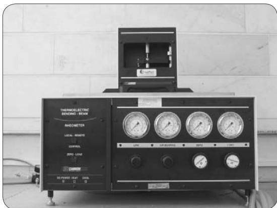
آزمایش بر روی قیرهای پیرشده در دستگاه PAV و RTFO انجام می‌شود. لذا ویژگیهای عملکردی قیر را هنگامی که در معرض اختلالاتگرم و یا پیرشدنگی در هنگام خدمت دهی قرار گیرد، اندازه‌گیری می‌نماید.
