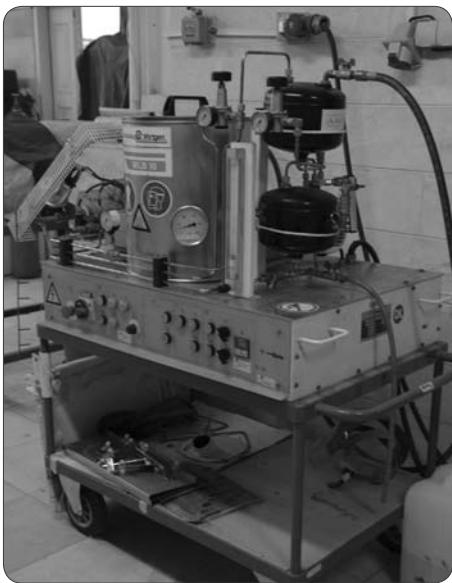
به منظور تهیه کف قیر و اختلاط مصالح با کف قیر جهت ساخت نمونه های مخلوط بازیافتی، از دستگاه آزمایشگاهی تولید کف قیر استفاده می شود. تولید کف در این دستگاه چنان تنظیم و کالیبره می شود که مشابه تولید واقعی ماشین بازیافت هنگام اجرای میدانی باشد.
