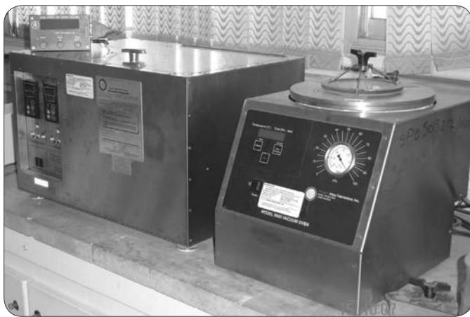
این آزمایش شامل پیرشدگی سریع (اکسیداسیون) قیرها با استفاده از هوای تحت فشار و دمای بالا است. این روش آزمایش به منظور شبیه سازی پیرشدگی قیر در زمان بهره برداری و خدمت دهی روسازی و بر روی قیر پس ماند آزمایش پیرشدگی کوتاه مدت لایه نازک متحرک قیر (RTFOT) انجام می گیرد. این آزمایش با هدف ارزیابی و سنجش مقاومت نسبی قیرهای مختلف در برابر پیرشدگی در دماهای مشخص انجام می پذیرد.
