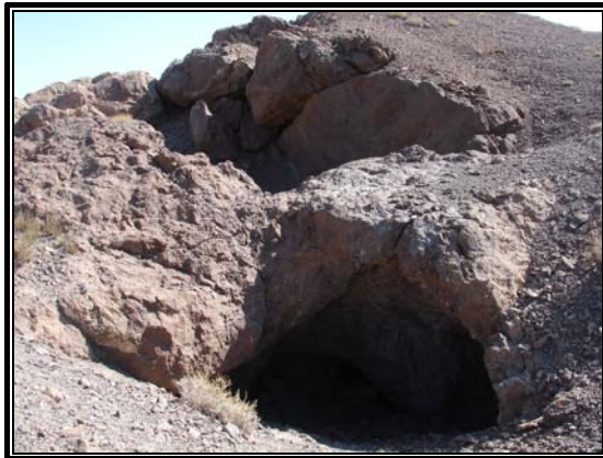
شکل ۳-۴۴- نمایی از کنده کاری های قدیمی در معدن آخوری ۲ که به شکل غار و تونل های امتداد رو حفر گردیده اند (نگاه بسمت شمال باختر).
