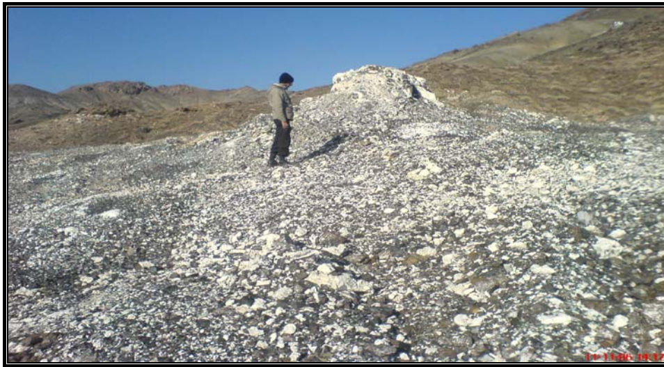
شکل ۳-۹۲- نمایی از یک رگه منیزیته به ضخامت ۱/۲ متر در معدن منیزیت فرومد (نگاه بسمت خاور).
