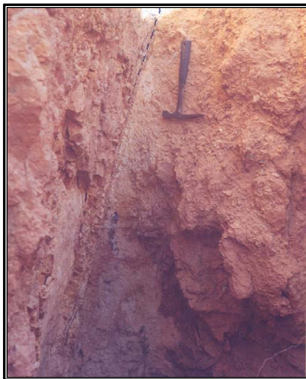
شکل ۳-۲۲- نمائی از رگه کانه‌دار در امتداد گسل در کارگاه شماره ۸ معدن سرب رضا آباد (نگاه بسمت باختر).
