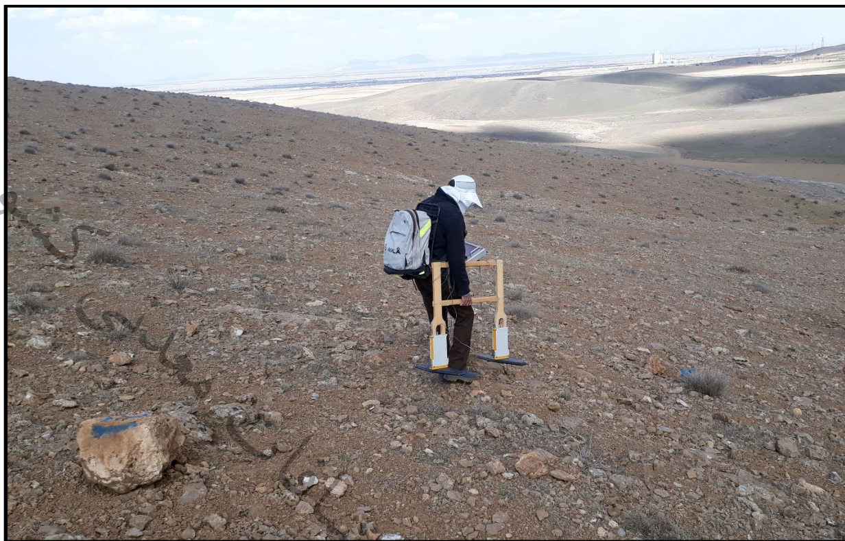
شکل ۳-۹: برداشت داده‌های GPR با آنتن ۲۰۰ مگاهرتز غیرپوششی در امتداد پروفیل P70 (دید به سمت شمال شرق)
