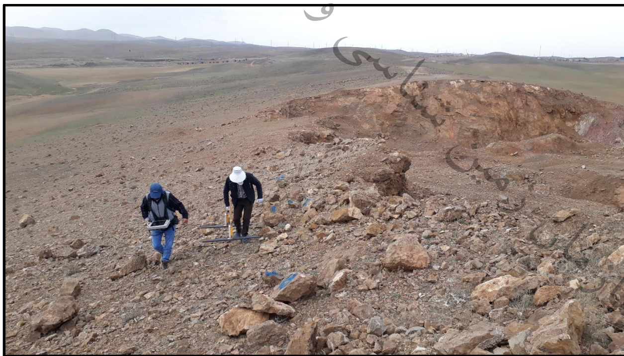
شکل ۳-۵: برداشت داده های GPR در امتداد پروفیل P115V (دید به سمت ابتدای پروفیل (جنوب))
