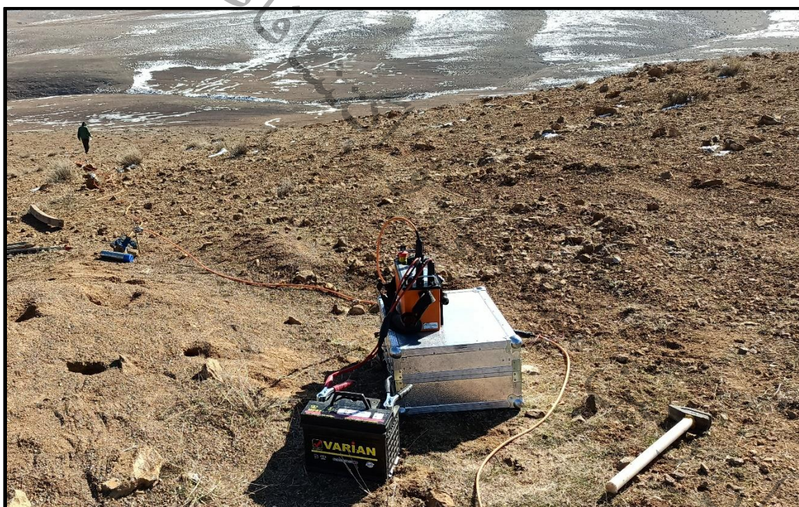
شکل ۳-۳: برداشت داده‌های مقاومت ویژه در امتداد پروفیل P60 (دید به سمت انتهای پروفیل (شرق))
