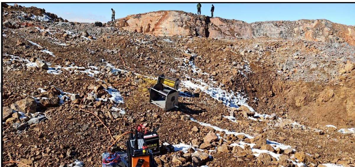
شکل ۲-۳: برداشت داده‌های مقاومت ویژه در امتداد پروفیل P15 (دید به سمت ابتدای پروفیل (غرب))
