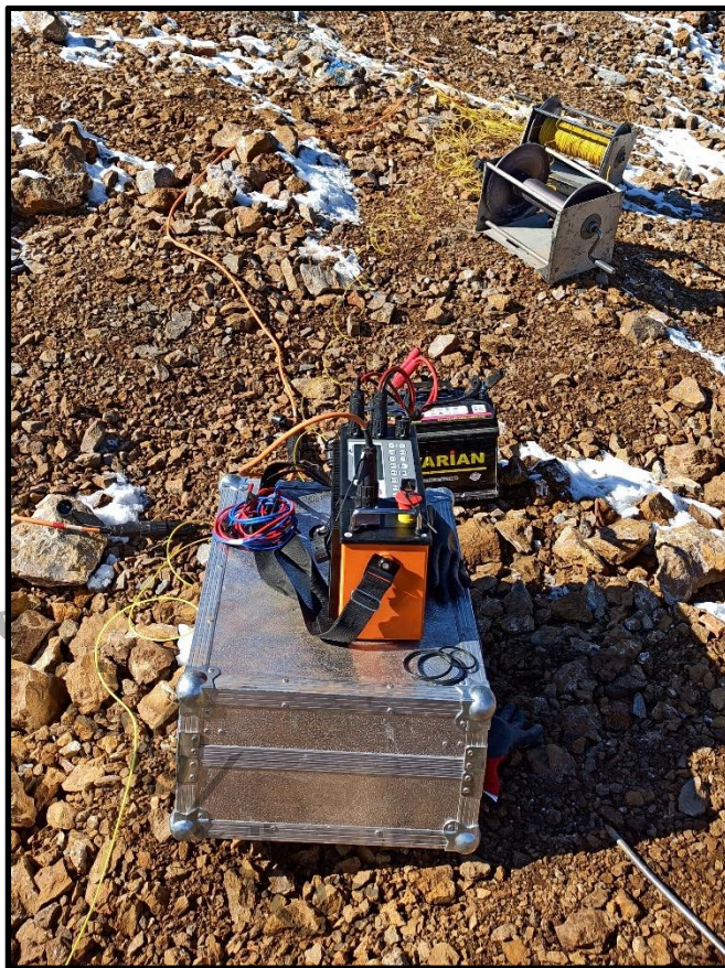
شکل ۳-۶: دستگاه ARES و تصویری از عملیات برداشت در حین اندازه گیری پروفیل P15
