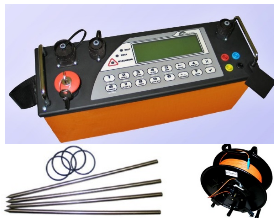
شکل ۳- تصویری از دستگاه و تجهیزات جانبی مقاومت ویژه الکتریکی (دستگاه ARES ساخت کشور چک)
