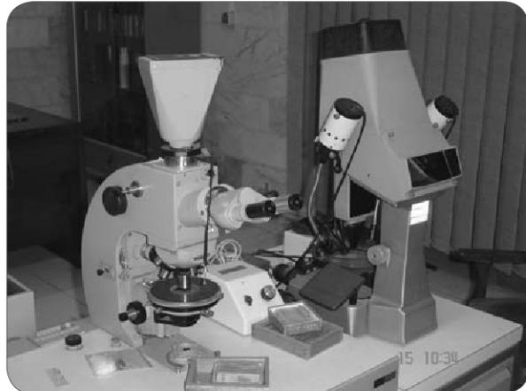
آزمایش‌های پتروگرافی بر اساس مشاهده مستقیم چشمی و میکروسکوپی انجام می‌پذیرد. با انجام این آزمایش همراه با آزمایش‌های تکمیلی نظیر XRD و آزمایش‌های شیمیایی بر روی مصالح سنگی (واکنش‌های قلیایی-سیلیسی، قلیایی-کربناتی و .... در آزمایشگاه شیمی و فیزیک) تا حدود زیادی می‌توان به ویژگی‌های بلندمدت بتن حاصل از این سنگدانه‌ها پی برد.
