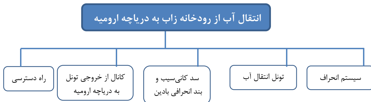
شکل ۱۶- اجزای اصلی طرح انتقال آب از رودخانه زاب به دریاچه ارومیه
