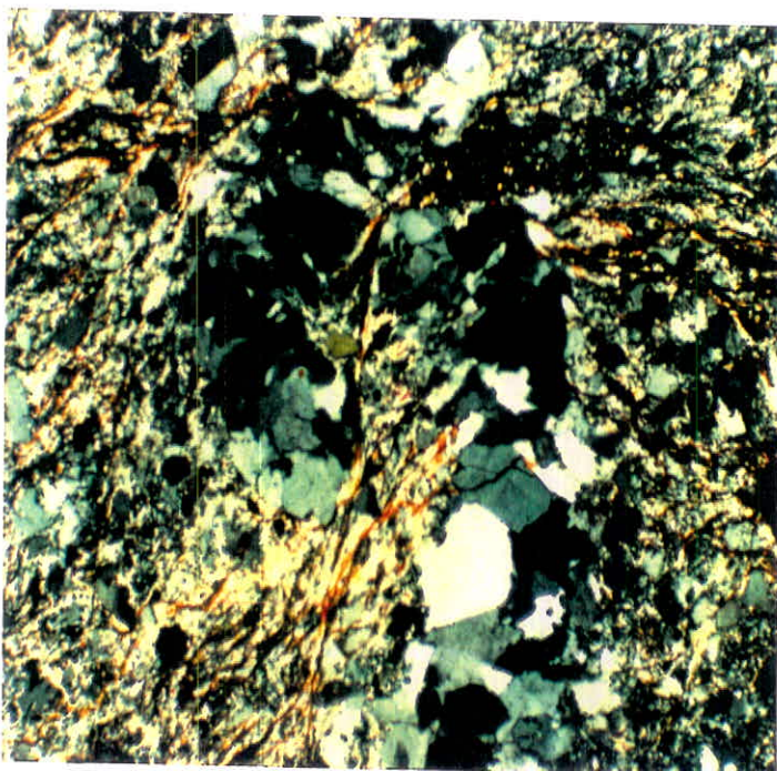
عکس (۳-۴۱) - تصویر میکروسکوپی ماسه سنگ دگرگون شده مسکویت دار. حضور مسکویت به این سنگ فولیاسیون بارزی داده است. در این تصویر یک رگه گوارتری نیز دیده می شود که پس از چین خوردن شکسته شده و به چند قسمت تبدیل گردیده است. فضای بین کانیها را نیز اکسید آهن پر کرده است (در نور پلاریزه، بزرگنمایی ۲۵).
