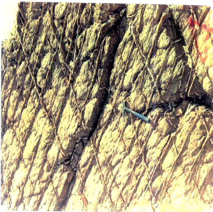
عکس شماره (۱۷-۳) - تصویر درزه های سیستماتیک پر شده توسط سیلیس. این نوع درزه ها با سنگهای سخت از جمله ماسه سنگها به وفور دیده می شود.
