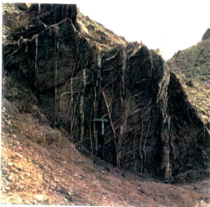
عکس شماره (۲۵-۳) - تصویری از رگه های کوارتزی با معرف دو نسل رگه نسل اول حالت قائم و ضخیم تر هستند، نسل دوم کم ضخامت تر و با زاویه ۴۵ درجه نسبت به نسل اول قرار می گیرند. رگه های نسل دوم غالباً حالت پله ای و ان اشلان نشان می دهند ( جنوب شرق گمانه BH-6).
