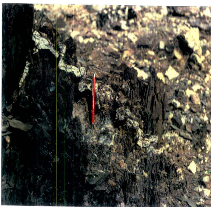
عکس شماره (۳۰-۳) - تصویر یک رگه سیلیسی چین خورده با سنگ میزبان ماسه سنگ کمی متورق شده. چین خورده بودن این رگه مبین آنست که در هنگام نهشته شدن سیلیس تنش های اعمال شده بر منطقه فعال بوده اند و باعث گردیده اند تا رگه سیلیس حالت چین خورده بخود بگیرد (شمال شرقی BH-2).
