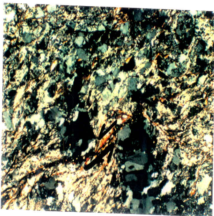
عکس شماره (۳-۴۰) - تصویر میکروسکوپی ماسه سنگ دگرگون شده مسکویت دار که توسط رگه کوارتزی قطع شده است. رگه های کوارتزی دارای دانه های کوارتز دانه درشت تری هستند. در این تصویر گسیختگی و جابجایی رگه کوارتزی در امتداد مسیر نشان داده شده با فلش مشاهده می شود و جابجایی چپگردی را نشان می دهد (در نور پلاریزه، بزرگنمایی ۲۵).
