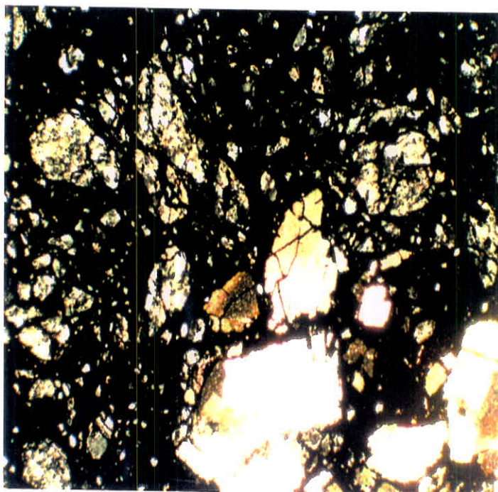
عکس شماره (۴۹-۳) - تصویر میکروسکوپی یک رگه کوارتزی شدیداً برشی شده که فضای بین شکستگیها توسط اکسیدهای آهن و منگنز پر شده است (در نور پلاریزه، بزرگنمایی ۲۵).
